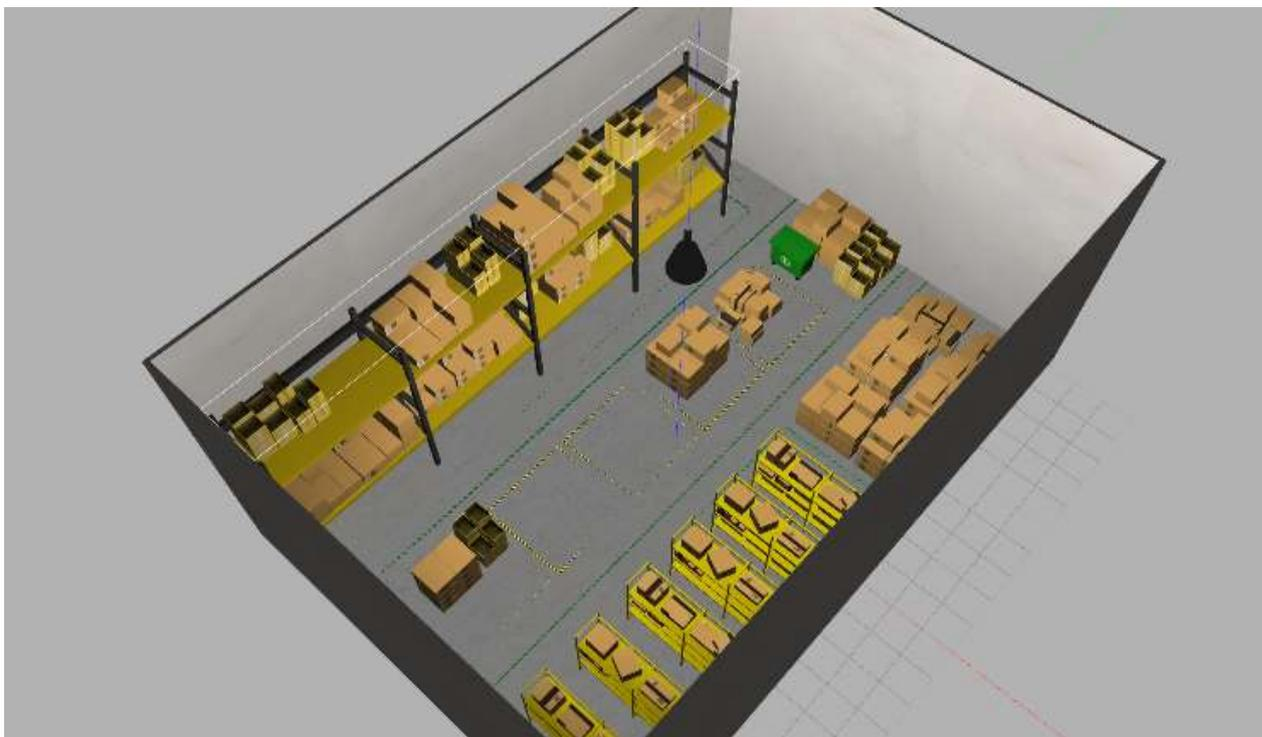
Рис. 4.3.1.1. Модель складского помещения AWS Robotics для симулятора Gazebo.
