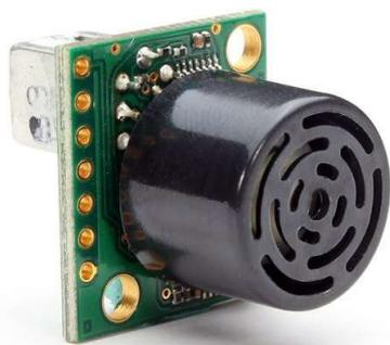
Рис. 5.2.1.2. Ультразвуковой датчик MB1242<sup>12</sup>.
