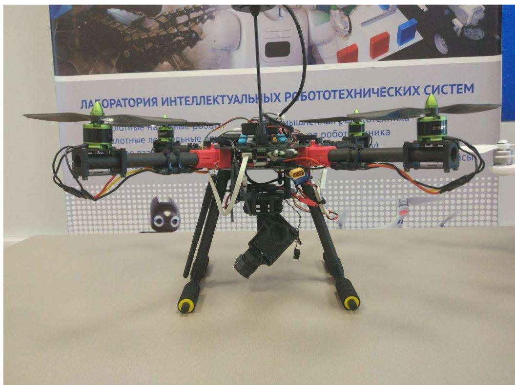
Рис. 3.4.2. БЛА PX4-LIRS на базе Pixhawk.
