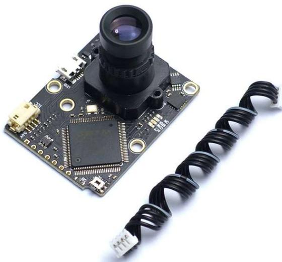
Рис.5.2.1.1. Камера оптического потока PX4Flow<sup>11</sup>.
