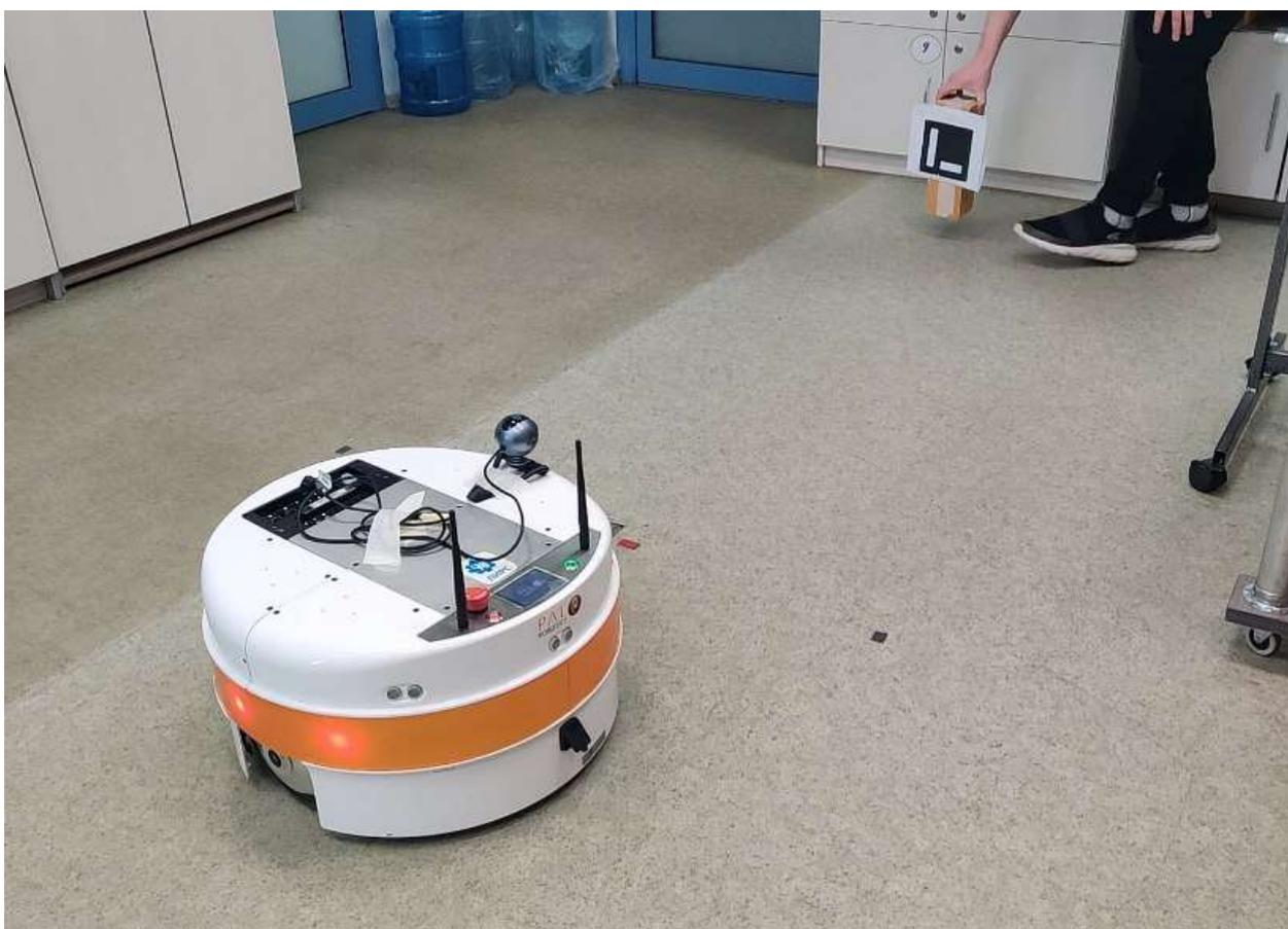
Рис. 7.1. Проверка работы ноды выравнивания мобильного робота TIAGo Base относительно обнаруженного ArUco-маркера.
