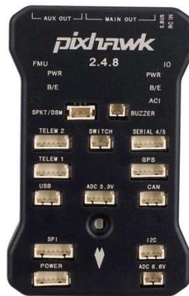
Рис. 3.4.1. Полетный контроллер Pixhawk
