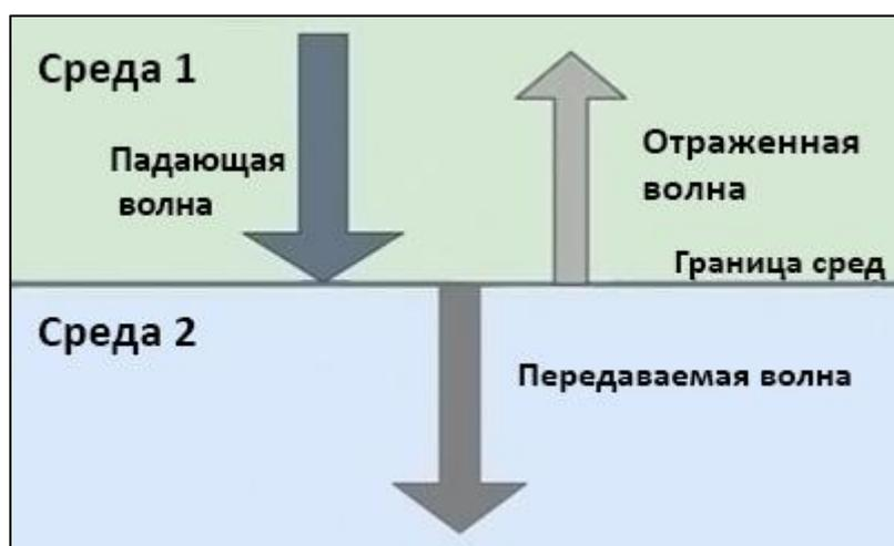
*Рисунок 4. Процесс передачи и отражения ультразвуковой волны.*
