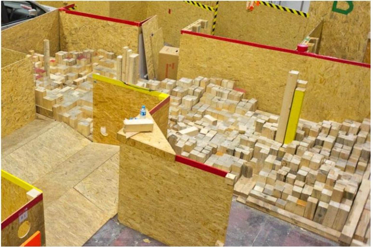
Рис. 26 RSE с непроходимыми пиками и стенами без границ между паллетами на соревновании RoboCup Rescue [19]
