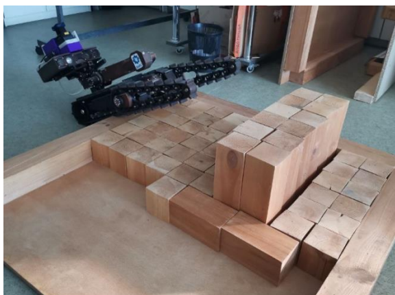
Рис. 32 а-б Испытания проходимости робота через горизонтальный барьер высотой в 20 см
