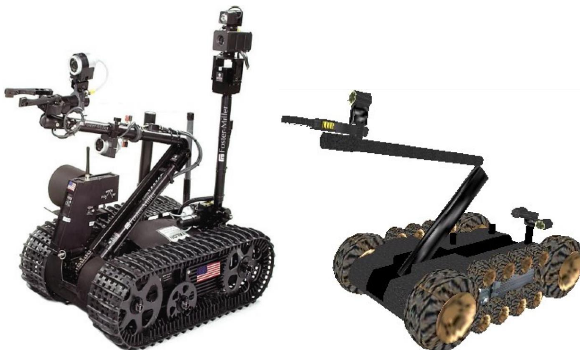
Рис. 7 а-б Гусеничный робот Talon (слева) и его модель в симуляторе USAR-Sim (справа) [35]
