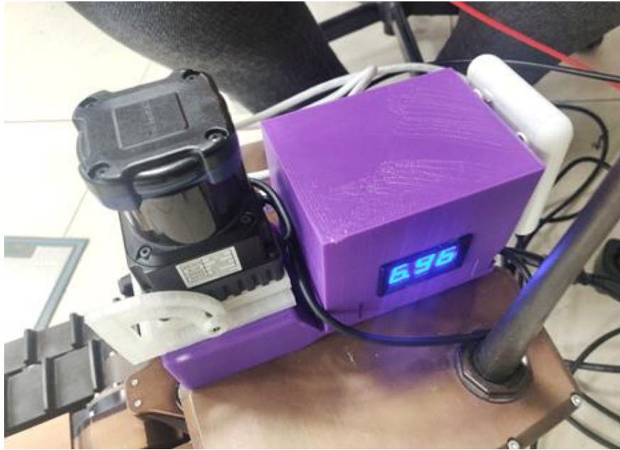
Рисунок 3.2.3.2. Подставка под лазерный дальномер на реальном роботе.
