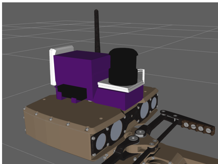
Рисунок 3.2.3.3. Подставка под лазерный дальномер на модели робота “Сервосила Инженер”
