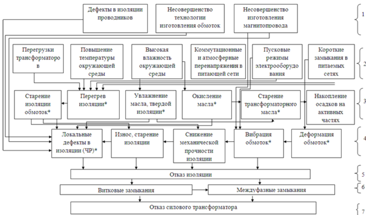
Рис. 2. Схема развития дефектов изоляции силового трансформатора:
