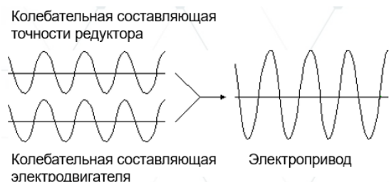
Рис. 2. Графическое представление работы в противофазе электропривода
