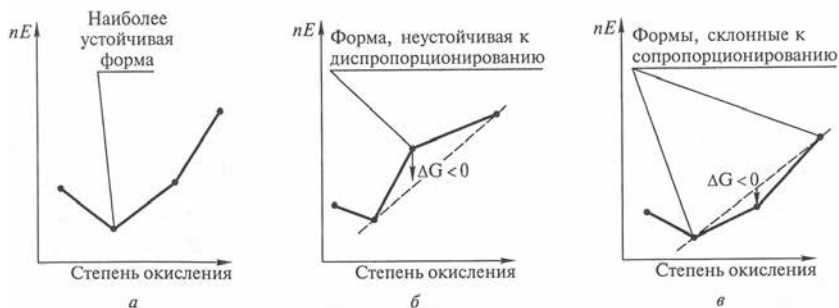
Рис. 3. Схемы диаграмм Фроста, иллюстрирующие наиболее стабильные окислительные формы (а), склонные к реакции диспропорционирования (б), и формы, склонные к реакциям сопропорционирования (в) [2].
