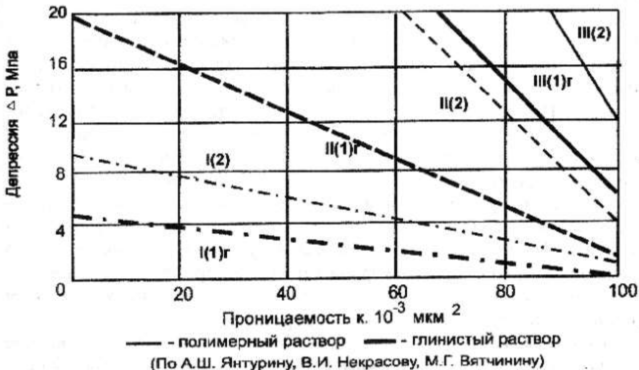
Рис. 9.1. Зависимость необходимой депрессии на пласт для декольматации призабойной зоны от типа бурового раствора и проницаемости пластов [58]
