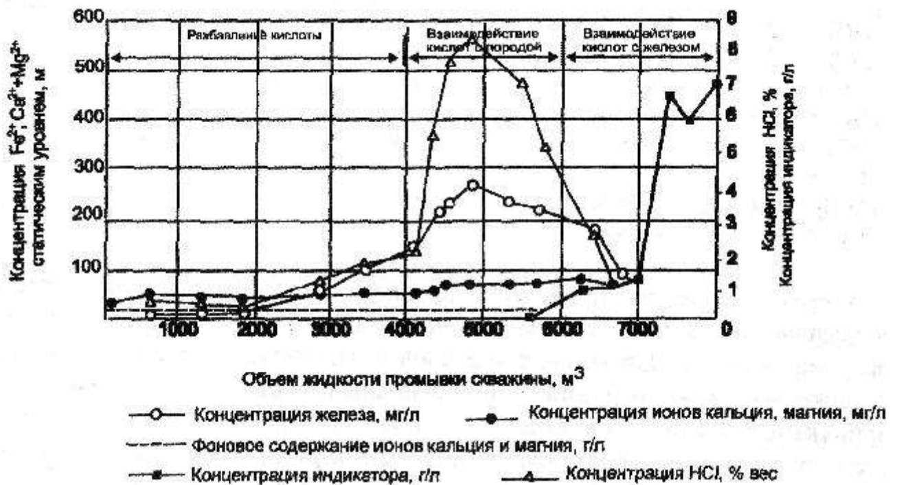
Рис. 9.3. Анализ продуктов реакции солянокислотного состава после проведения динамической кислотной ванны по скважине 54 Осташковичского месторождения (04.1989 г.) [61]
