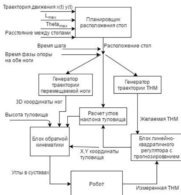
Рис. 3. Блок-схема алгоритма управления движением робота
