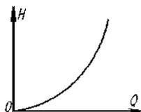
Рис. 4. 2. Характеристическая кривая простого трубопровода при турбулентном режиме
