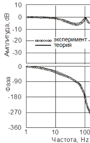
Рис 4. Частотные характеристики гидравлической линии, нагруженной на дроссель Передаточная функция (4) не учитывает динамику самого электрогидравлического усилителя. Если изучаются характеристики всей системы (с учетом ЭГУ) выражение необходимо умножить на передаточную функцию усилителя.
