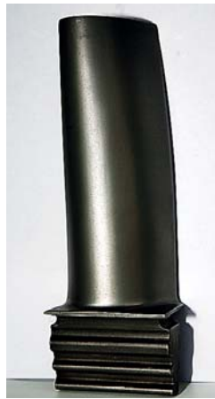
Рис. 1. Поверхность турбинной лопатки после обработки методом ГАО в стационарной установке
