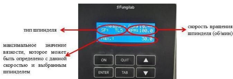
Рис. 8. Интерфейс “Measurement”. Основные функции измерения вязкости
