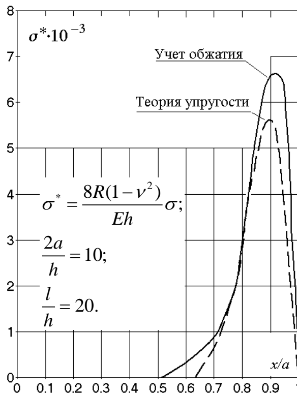
Рис. 3.4. Сравнение контактных напряжений, полученных по теории упругости и теории пластин с учётом обжатия
