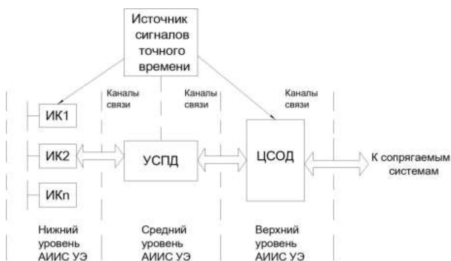
Рис. 2 Обобщенная структурная схема многоканальной АИИС КУЭ
