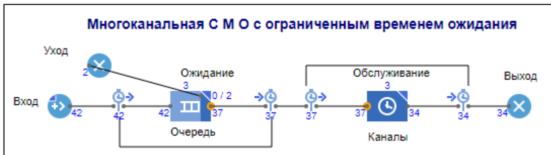
Рис. 8 Структура модели в среде AnyLogic
