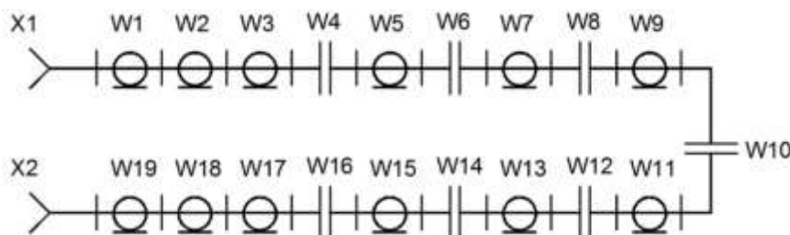
Рис. 1 Принципиальная схема фильтра 1680 - 1950 МГц
