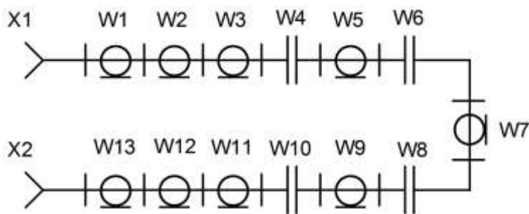
Рис. 8 Принципиальная схема фильтра 1680 - 1800 МГц
