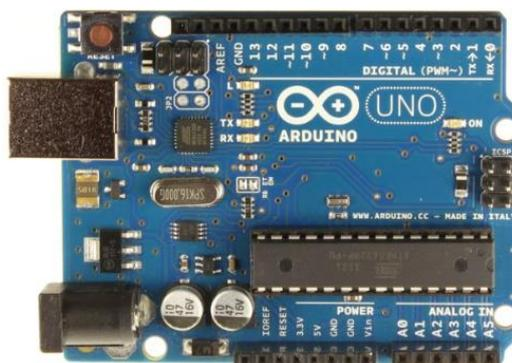
Рис.3. Внешний вид платы ARDUINO UNO.
