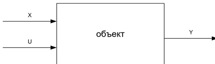
Рис. 2. – Схематическое изображение безынерционной системы
