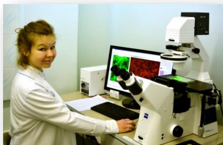
Флуоресцентный микроскоп для визуализации хромосом и экспрессии белков
