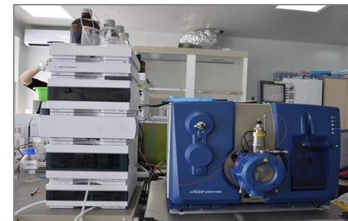
Масс-спектрометр сверхвысокого разрешения для количественной протеомики
