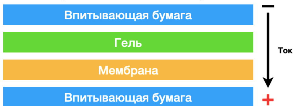
Рис. 14. Схема сбора «сэндвича» для переноса белков на мембрану
