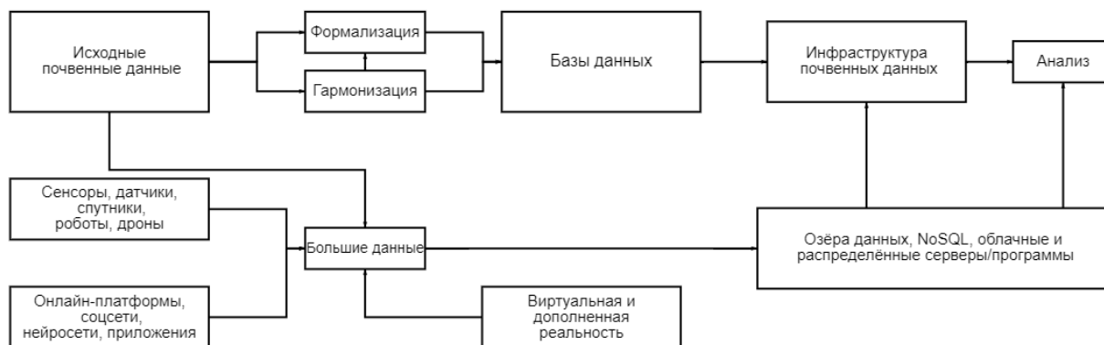
Рисунок 1. Блок-схема получения, обработки и анализа почвенных данных
