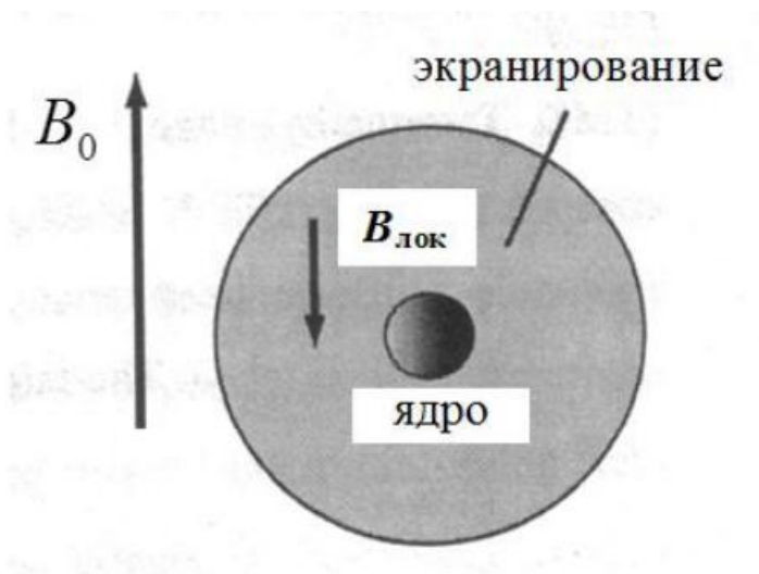
Рисунок 3 – Схематическое представление возникновения вторичного магнитного поля B_{\text{лок}}
