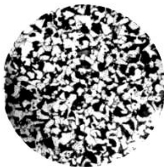
Рис.3 - Микроструктуры доэвтектоидной стали, \times 340 :
