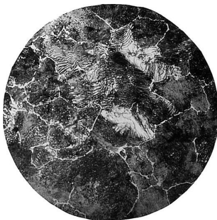
Рис.5 – Микроструктура заэвтектоидной стали, \times 340 :
