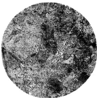
Рис.4 – Микроструктуры эвтектоидной стали, \times 340 :
