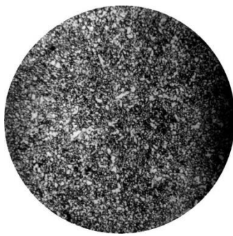
Рис.4 – Микроструктуры эвтектоидной стали, \times 340 :
