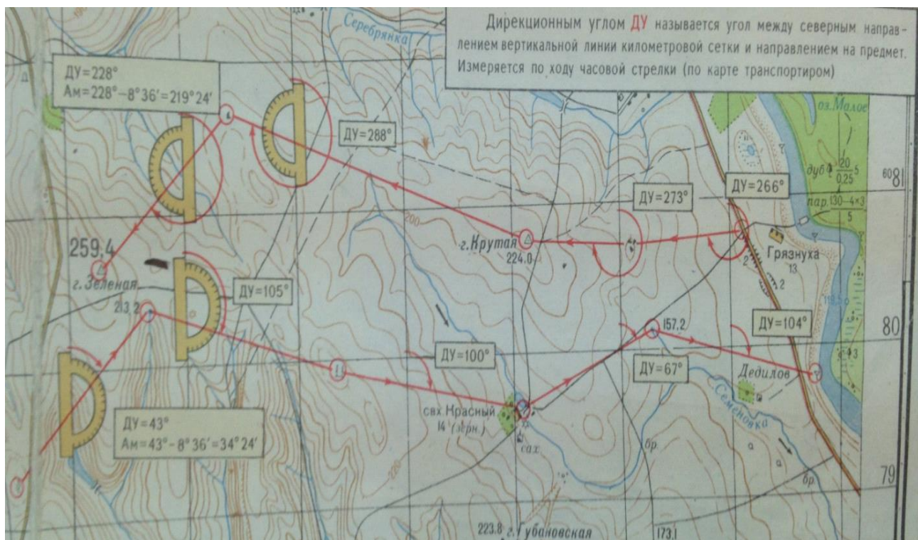
Рис. 13. Измерение дирекционного угла транспортиром
