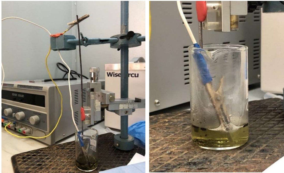
Рисунок 19 – Вид установки для травления стального провода с помощью 10%-ной соляной кислоты
