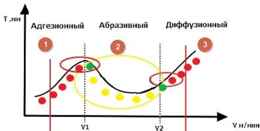
Рисунок 3 - Расчет износа инструмента на карте с учетом поправочных зон для твердосплавного инструмента
