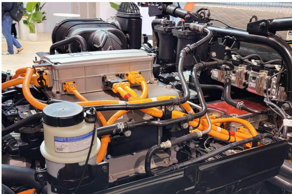
Рисунок 1 - Блок водородных топливных элементов в грузовике Hyundai XCIENT
