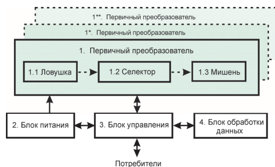
Рис. 1. Схема составляющих ионозонда: 1, 1*...1** – первичные преобразователи, 2 – блок питания, 3 – блок управления, 4 – блок обработки данных, 1.1 – ловушка, 1.2 – селектор, 1.3 – мишень
