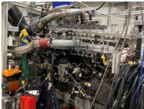
Рис. 5 Стендовый образец с системой ORC ф. Navistar
