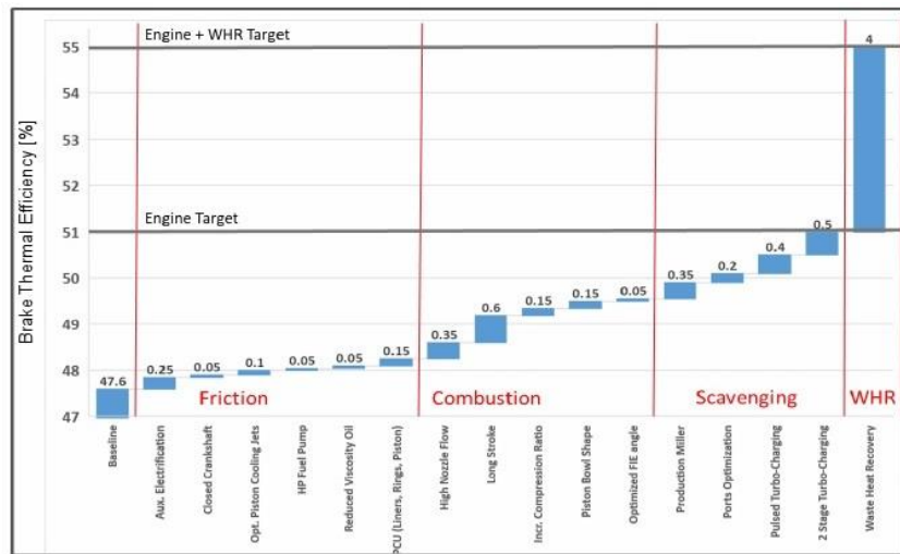
Рис. 4 Вклад технологий в повышение теплового КПД дизелей Ренар
