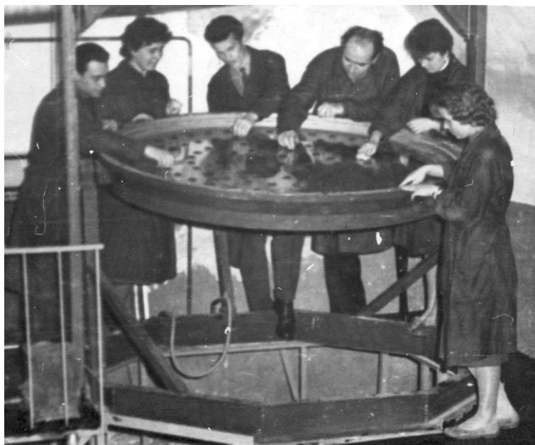
Сотрудники лаборатории подземной гидромеханики готовят модель нефтяного пласта к проведению экспериментов, 60-е годы XX века
