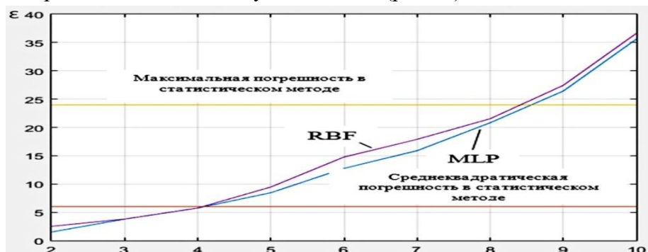
Рис.1. График зависимости погрешности прогнозирования \varepsilon – индекса от значения шага прогнозирования в MLP и RBF
