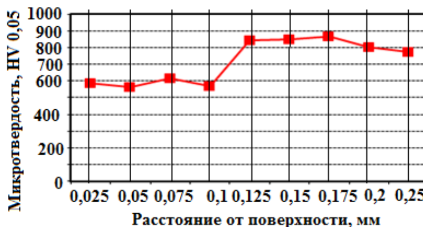
Рис. 6. График изменения микротвёрдости в единицах HV_{0,05} по глубине после наплавки.
