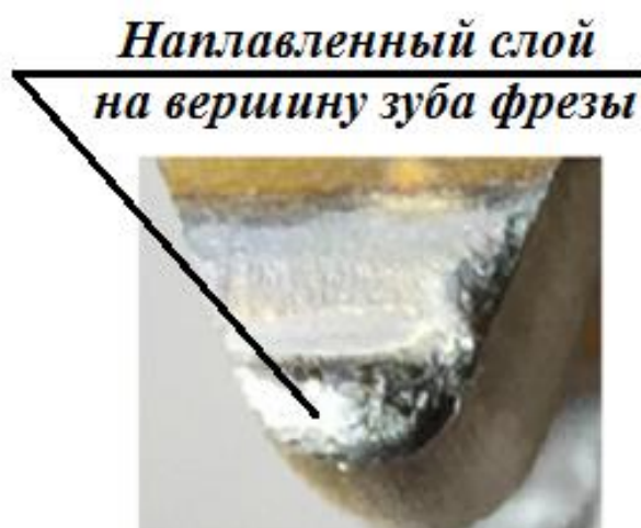
Рис. 5. Внешний вид зуба фрезы после наплавки.
