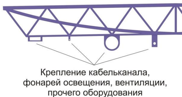
Рис. 4. Строительная ферма с монолитными крепежными узлами
