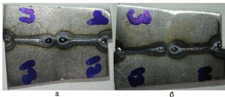
Рис. 4. Сварочное соединение 1.12-13: а – вид спереди; б – вид сзади
