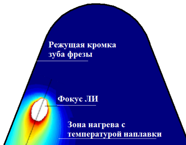
Рис. 4. контур движения фокуса ЛИ по РКИ во время наплавки.
