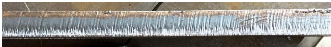
Рис. 6. Стыковая поверхность стали 12Х2Н4А после ЛР.
