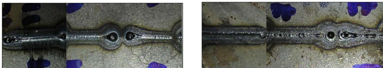
Рис. 1. Общий вид швов № 5-7.1-7.2 и 11-12-13 соответственно (слева-направо) На рис. 2. показан образец 3 толщиной 3 мм из конструкционной стали.
