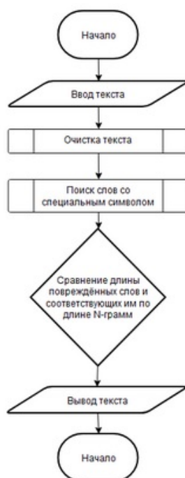
Рис. 2. Блок-схема алгоритма восстановления поврежденного текста
