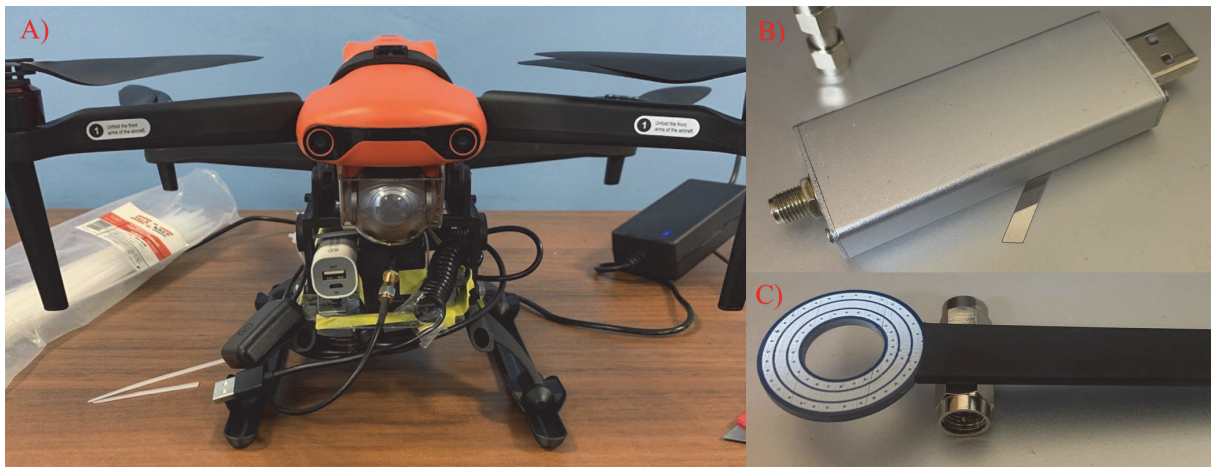
Рис. 1. Панель А: внешний вид Autel EVO 2 с измерительной системой в сборе. Панель В: приемник RTL-SDR v3. Панель С: рамочная магнитная антенна
