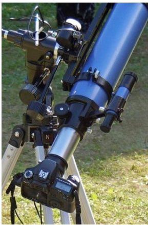
Рис. 1.2. Соединение фотоаппарата с телескопом через Т-адаптер.
