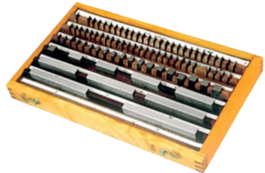
Концевые меры длины плоскопараллельные стальные.
