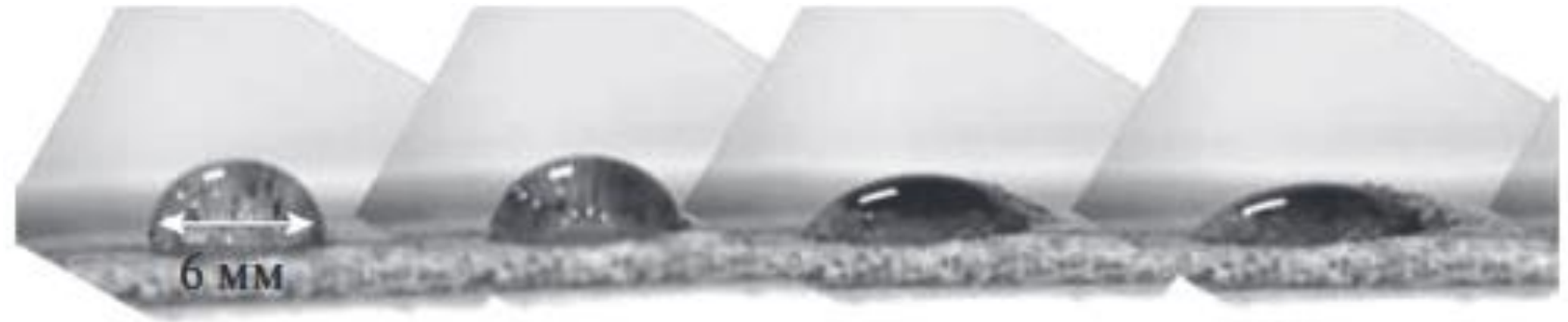
Растекание капли смачивающей жидкости по твердой поверхности
