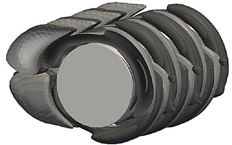
Трёхмерное моделирование обтекания цилиндра
