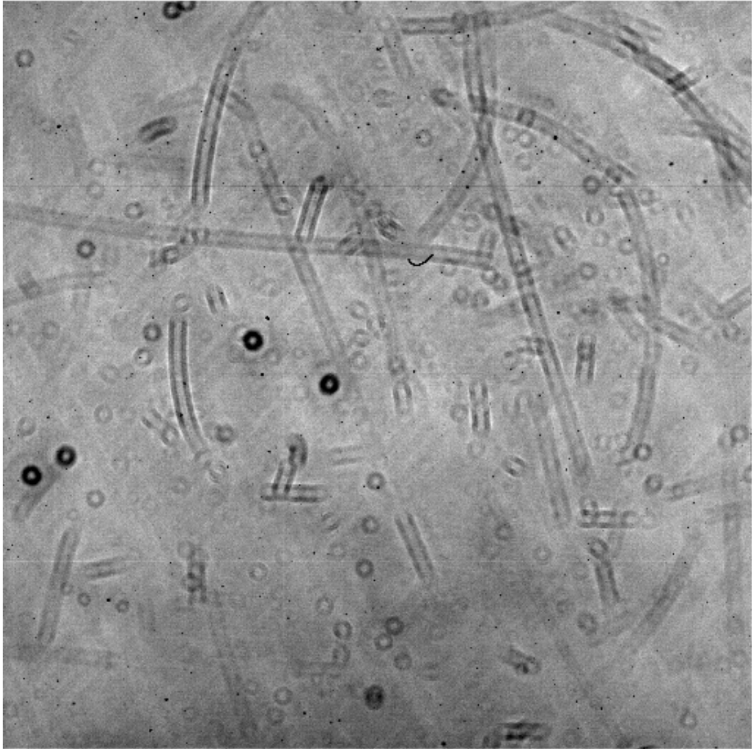
Рис. 3.5. Пример кадра плоского поля. Видны пиксели с пониженной чувствительностью, следы пылинок и царапин на защитном стекле матрицы
