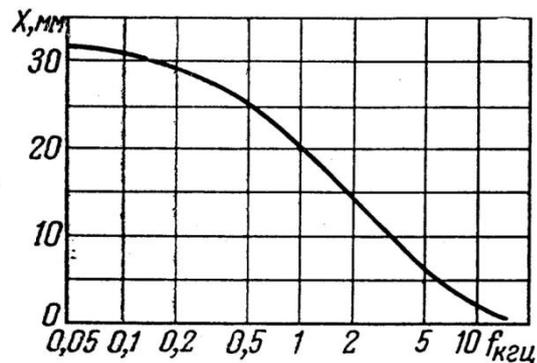
Рис. 1. Зависимость местоположения максимума поперечных колебаний основной мембраны улитки от частоты возбуждающего тона (Цвикер, Фельдкеллер 1971, рис. 33.4). По оси абсцисс частота тона в "кГц", по оси ординат – расстояние от основания улитки в "мм"
