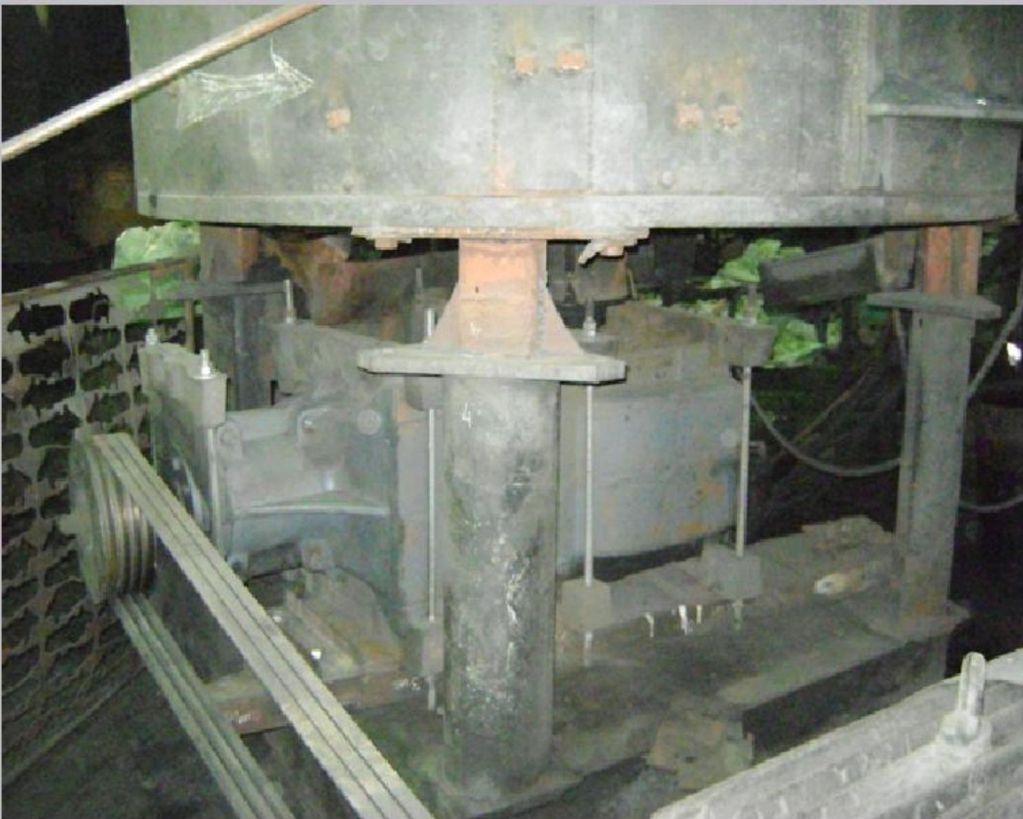
**Редуктор установлен на раму и закреплен силовыми частями.**
