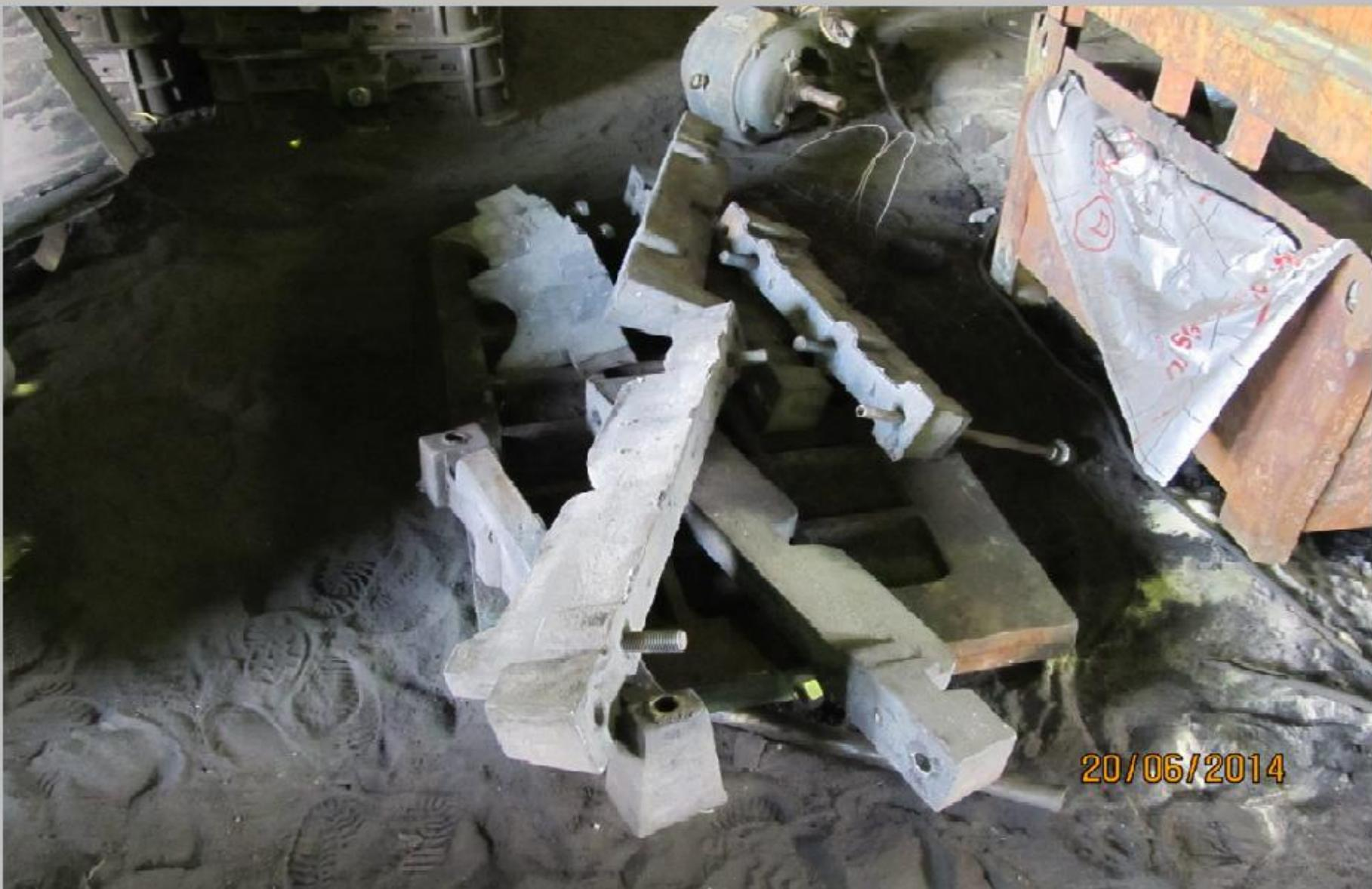
Отливки силовых частей станины из ЧВГ. Ключевые характеристики отливок - размерная точность прилегающих поверхностей и отсутствие внутренних усадочных дефектов. Масса отливок с влитыми анкерами 67 - 130 кг
