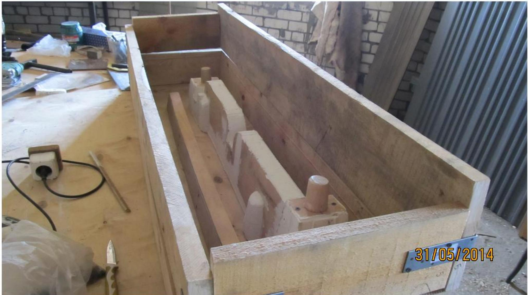
Процесс изготовления литейной оснастки для ХТС
