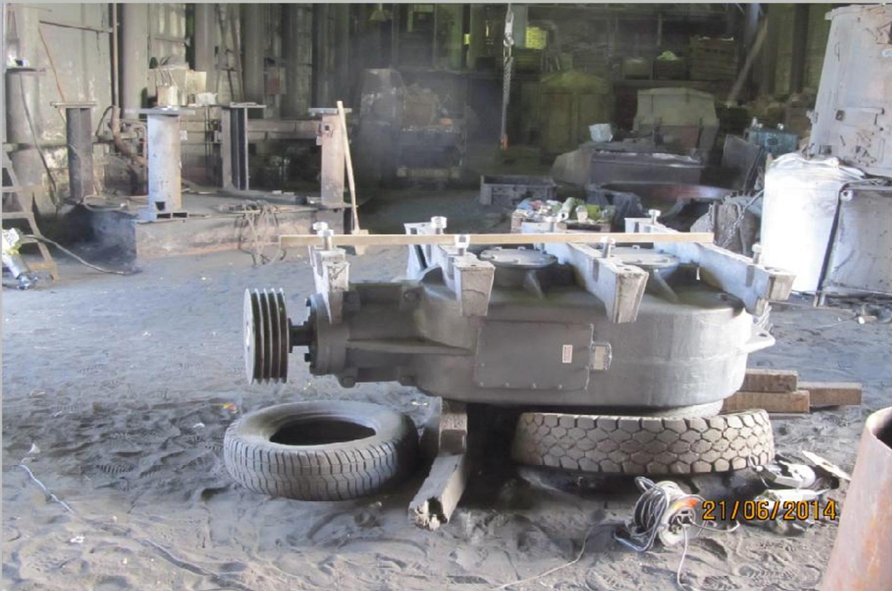
Отливки нижних элементов установлены на редуктор КЦ 1 - 500. Проверка отклонения от прямолинейности показала высокую точность отливок благодаря незначительной линейной усадке ЧВГ.
