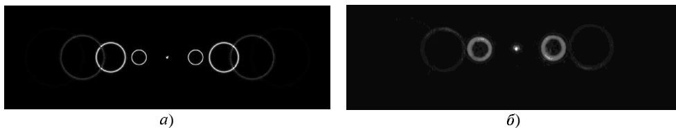
Рис. 6. Мультиплицирование поля вихревого аксикона при восстановлении голограммы. Численное моделирование (а), экспериментальный результат (б)
