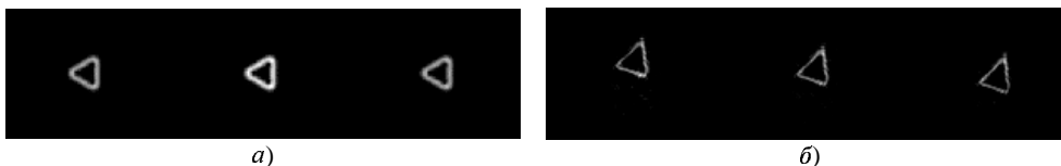
Рис. 5. Мультиплицирование спирального пучка на дифракционной решетке. Численное моделирование (а), экспериментальный результат (б). Период решетки d = 0.019 мм
