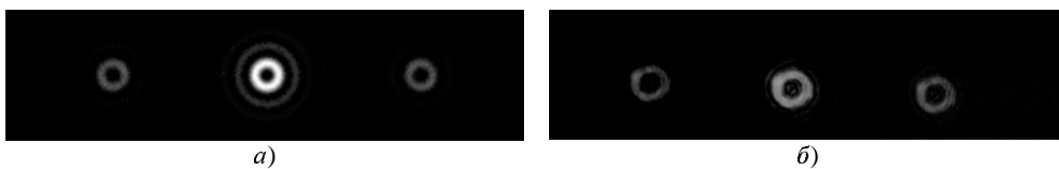
Рис. 4. Мультиплицирование поля вихревого аксикона на дифракционной решетке. Численное моделирование (а), экспериментальный результат (б). Период решетки d = 0.019 мм
