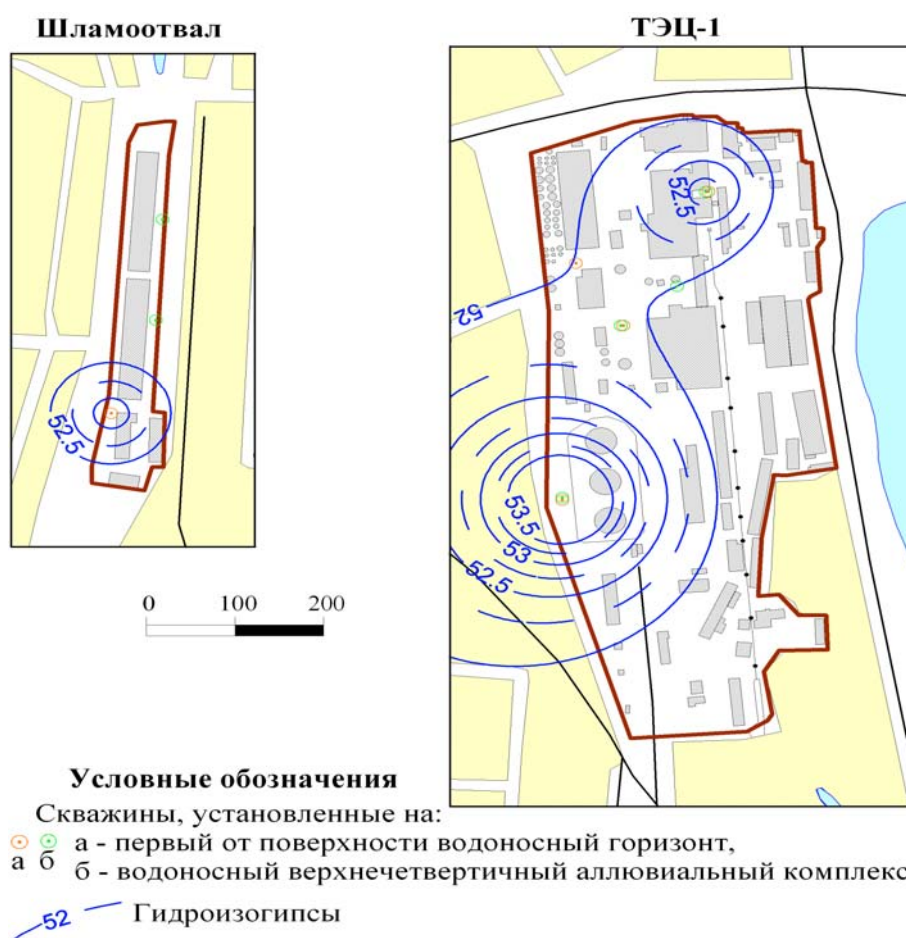
Рис. 4. Карта гидроизогины первого от поверхности водоносного горизонта (по состоянию на 15 ноября 2007 г.)
