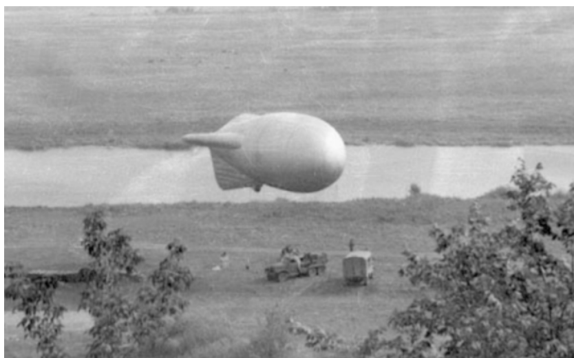
Фото 3.47. Запуск аппаратуры по измерению аэрозольного состава атмосферы с помощью аэростата
