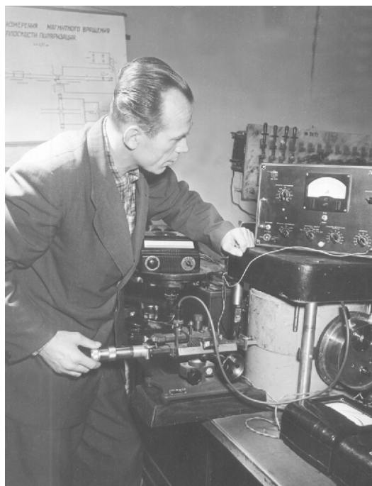
Фото 2.36. Н.Н.Непримеров проводит эксперимент на установке по измерению магнитного вращения плоскости поляризации
