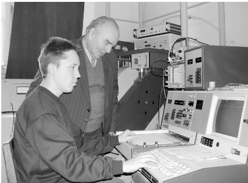
Фото 3. 87. Спектры ЭПР на приборе ESP-300 Bruker измеряет инженер Д.Г.Зверев, под руководством проф. М.М.Зарипова
