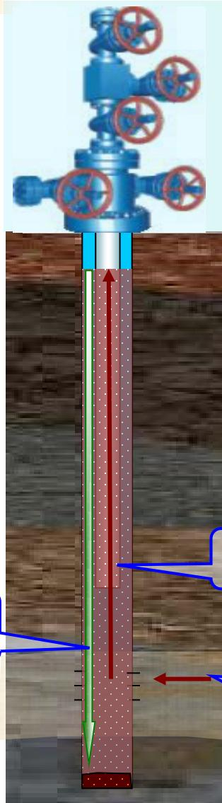
При котором нефть на дневную поверхность поднимается с помощью энергии сжатого газа, вводимого в скважину с поверхности
