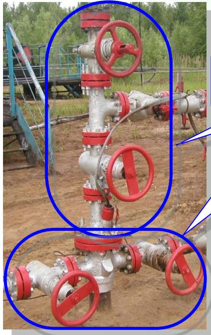
Фонтанная арматура состоит из двух элементов: **трубной головки и фонтанной елки**.
