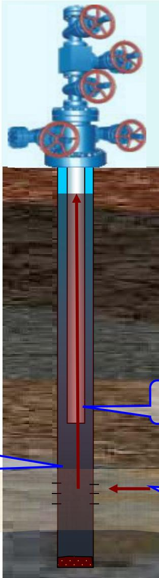
**Способ эксплуатации, при котором нефть из скважины поступает на дневную поверхность поднимается самоизливом за счет энергии пласта**
