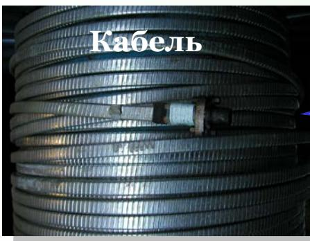
Электроэнергия на двигатель подается через специальный бронированный кабель.
