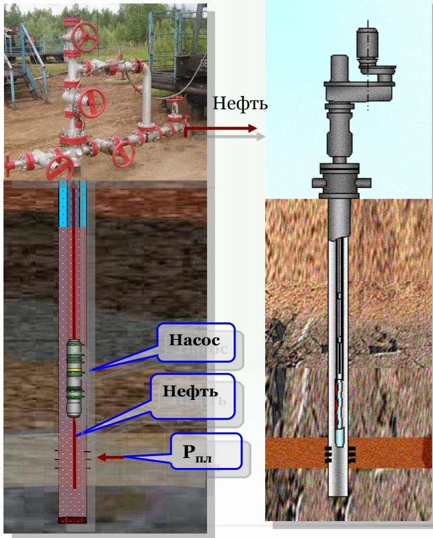
**Способ эксплуатации, при котором нефть поднимается из скважины механизированным способом с помощью насосов:**
