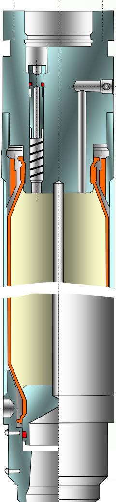
**Протектор** предназначен для защиты от попадания пластовой жидкости в маслонаполненный электродвигатель и предотвращает утечки масла при передаче вращения от электродвигателя к насосу.
