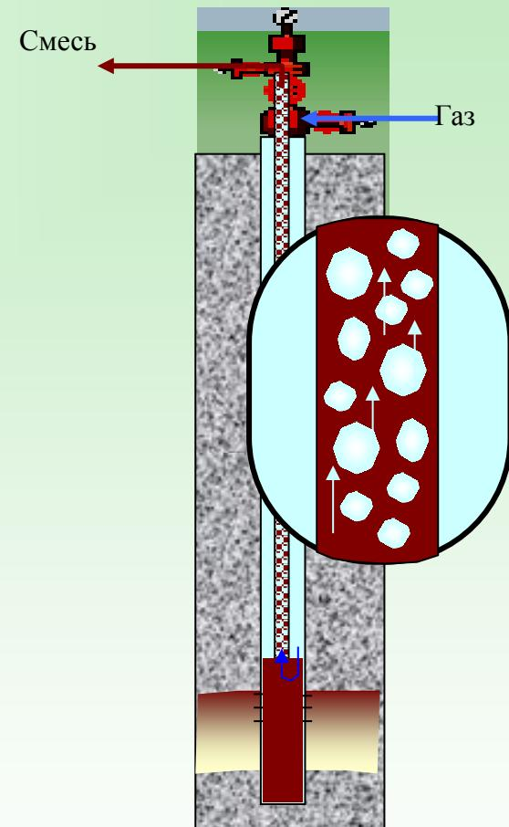
**Сущность газлифта** - газирование жидкости. При этом плотность газожидкостной смеси (а следовательно, давление ее столба в скважине) с ростом газосодержания уменьшается, забойное давление скважины снижается. Приток продукции зависит от расхода газа.
