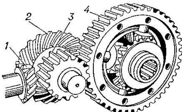
11. Определите передаточное число изображенного на схеме привода, если число зубьев на 1, 3 и 4 колесах в два раза меньше, чем число зубьев на 2 и 5 колесах. (ОК-1, ОК-2; ОК-3;ОК-4, ОК-8, ОК-9, ПК-1.3, ПК-4.1, ПК-4.4)
