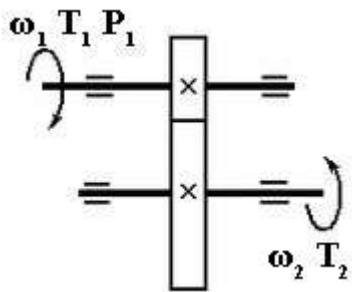
21. Определите **число оборотов в минуту  $n_1$**  ведущего вала плоскоременной передачи, если известно, что ведомый вал вращается со скоростью  **$n_2 = 6$  оборотов в секунду**, диаметр ведомого вала  **$D_2 = 0,45$  метра**, диаметр ведущего вала  **$D_1 = 30$  см.** (OK-1, OK-2; OK-3;OK-4, OK-8, OK-9, ПК-1.1, ПК-1.3, ПК-4.1, ПК-4.4)
