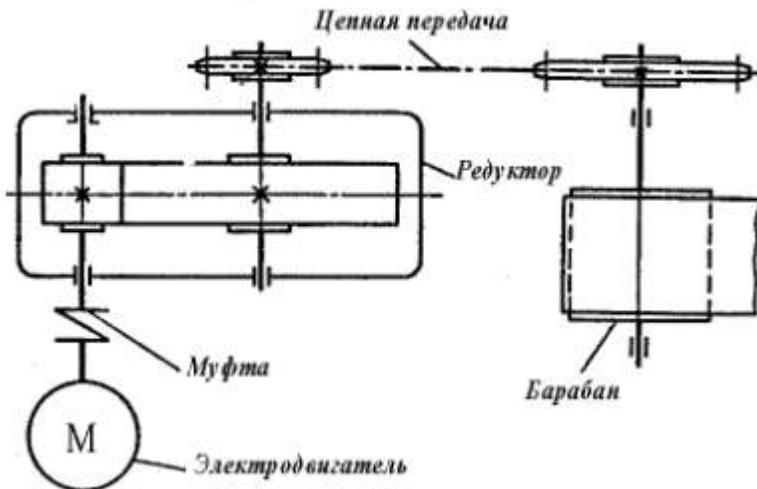
**16.** Назовите передачи, входящие в состав изображенного здесь привода. Определите ведущий и ведомый валы. Ответ обоснуйте. (ОК-1, ОК-2; ОК-3;ОК-4, ОК-8, ОК-9, ПК-1.3, ПК-4.1, ПК-4.4)
