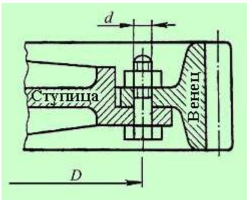
Определить касательные напряжения сдвига (среза), действующие в каждом из болтов при номинальной нагрузке. При расчете не учитывать ослабление стержня болта впадинами резьбы.
