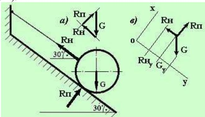
Для реакций мы знаем лишь их направление (величина сил неизвестна). От концов вектора силы  $G$  откладываем отрезки прямых, параллельные реакциям, и точка пересечения этих прямых позволит нам получить искомый треугольник сил. Теперь можно определить величину любой из реакций, измерив ее длину на чертеже линейкой и умножив на масштаб чертежа, который задает сила  $G$ . Порядок построений показан на рисунке *a*).
