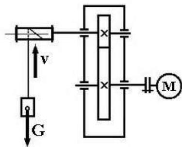
5. Определите передаточное число привода, представленного на схеме, если диаметры 1, 3 и 4 зубчатых колес равны 10 см, а диаметры 2 и 5 колес – 200 мм. (ОК-1, ОК-2; ОК-3;ОК-4, ОК-8, ОК-9, ПК-1.3, ПК-4.1, ПК-4.4)
