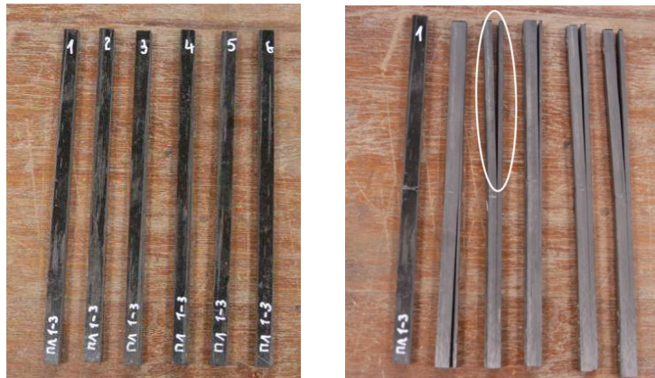
Рис. 7. Удлиненные тест-образцы: слева – до испытаний, справа – после испытаний
