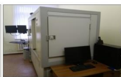
МИКРОФОКУСНАЯ СИСТЕМА РЕНТГЕНОВСКОГО КОНТРОЛЯ С ФУНКЦИЕЙ КОМПЬЮТЕРНОЙ ТОМОГРАФИИ НА БАЗЕ РЕНТГЕНОВСКОЙ УСТАНОВКИ NIKON METROLOGY XT H 225+180 LC
