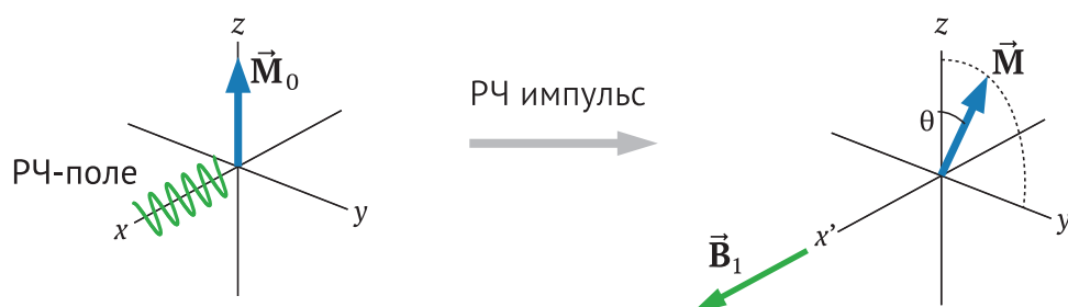
Рисунок 6 — Под действием радиочастотного импульса длительностью \tau_p и амплитудой \vec{B}_1 вектор намагниченности поворачивается на угол \theta = \gamma B_1 \tau_p
