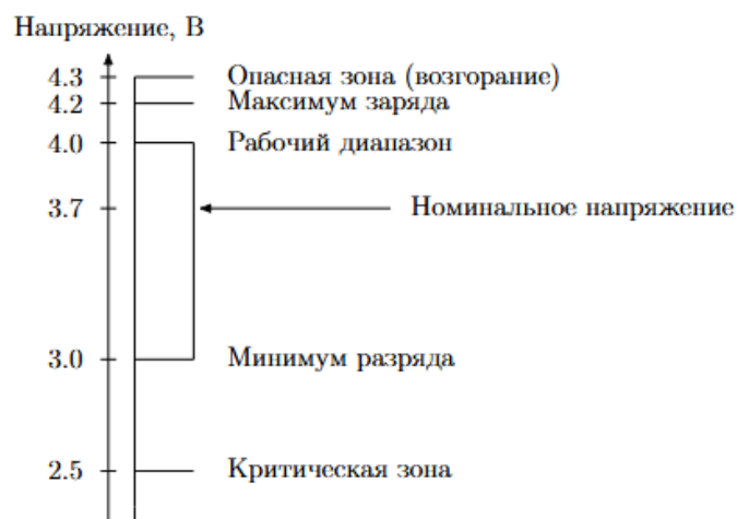
Рис. 42. Характеристические напряжения LiPo элемента:
