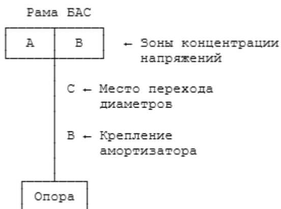
Рис. 28. Типичные места образования трещин в стойках ВПУ
