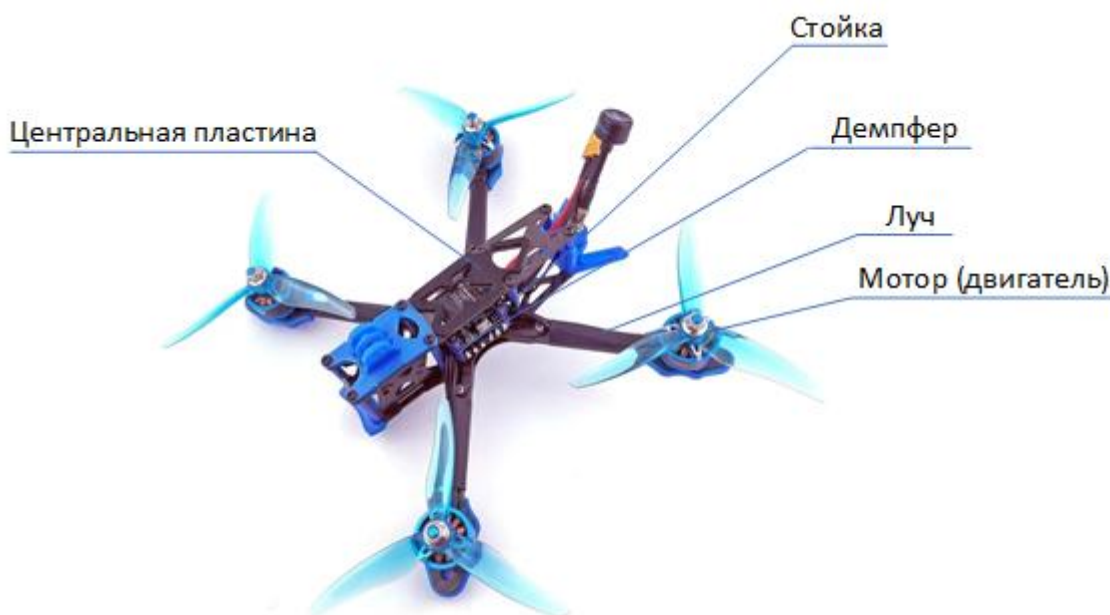
Рис. 3. Основные элементы рамы квадрокоптера
