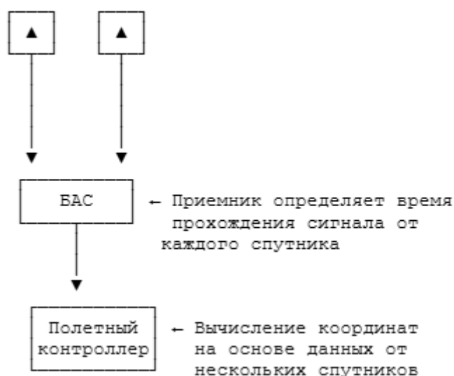
Рис. 7. Принцип работы спутниковой навигационной системы
