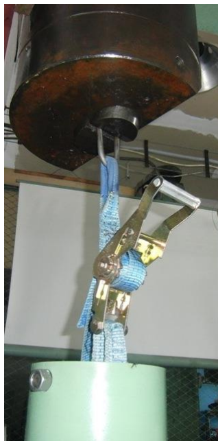
Рисунок 1. Лабораторные исследования для определения рабочей нагрузки для ретчета производства ТМ КРОК [4]
