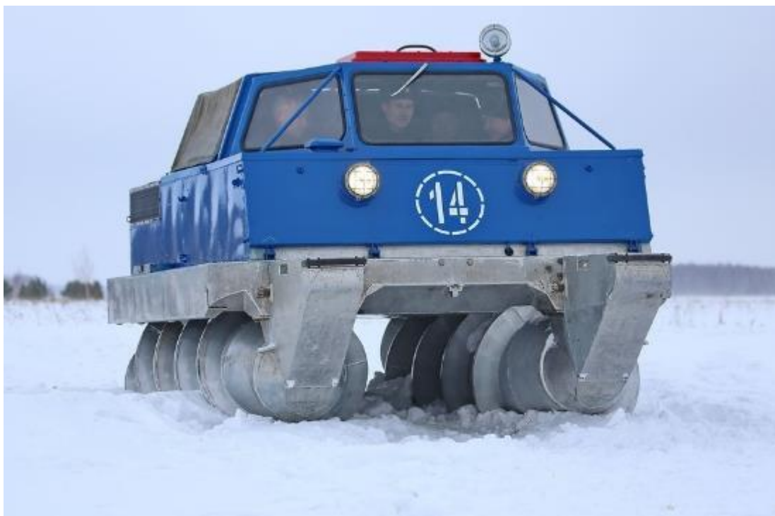
Рисунок 3 – Вездеход на шнеко-роторном движителе
