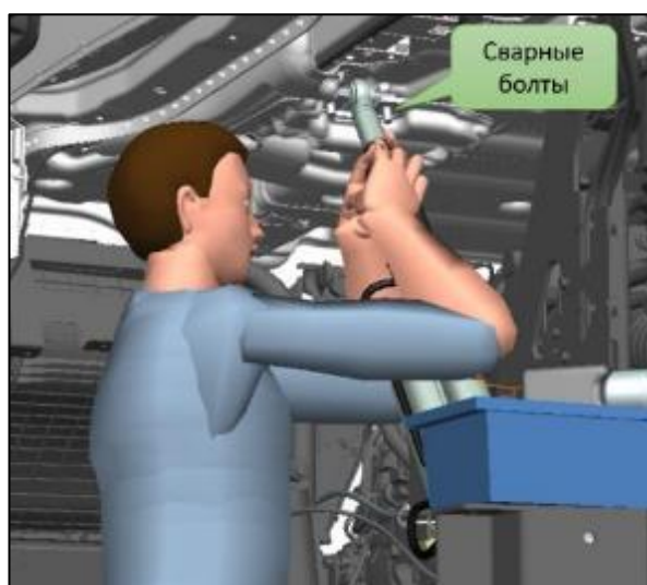
Рис.4 – Процесс установки гидроцилиндра в сборе с болтами
