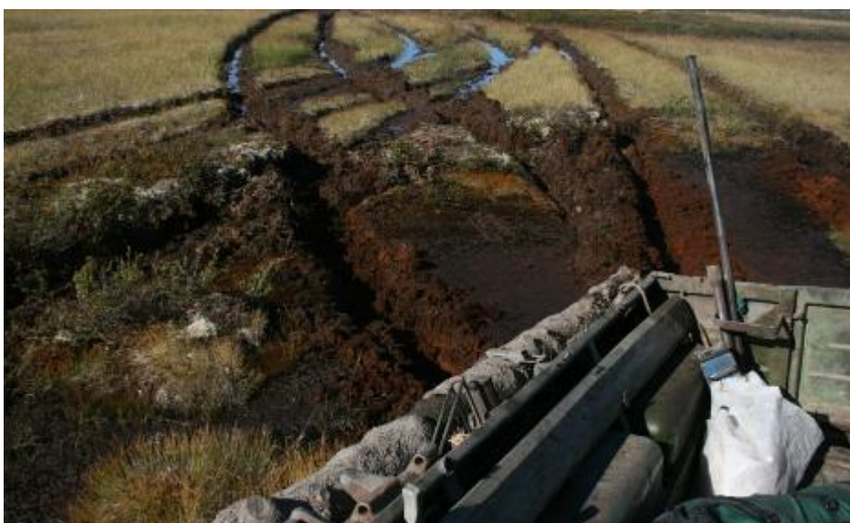
Рисунок 1 – Влияние гусеничного двигателя на верхний растительный слой тундры
