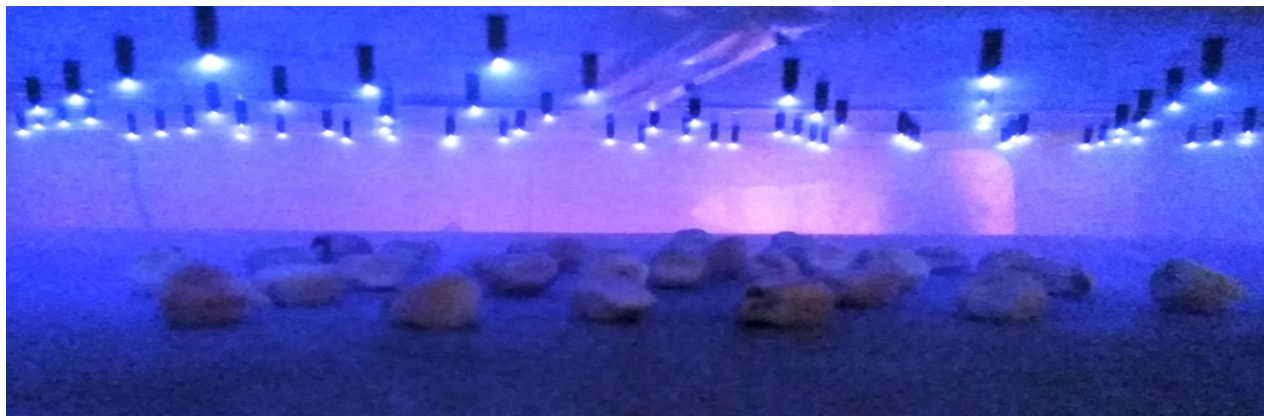
Рис. 1. Плазменная обработка семян кукурузы в ТРАД. Межэлектродное расстояние d = 2 см.
