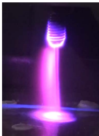
Рис. 1. Форма ВЧ разряда со струйным течением электролита в процессе обработки
