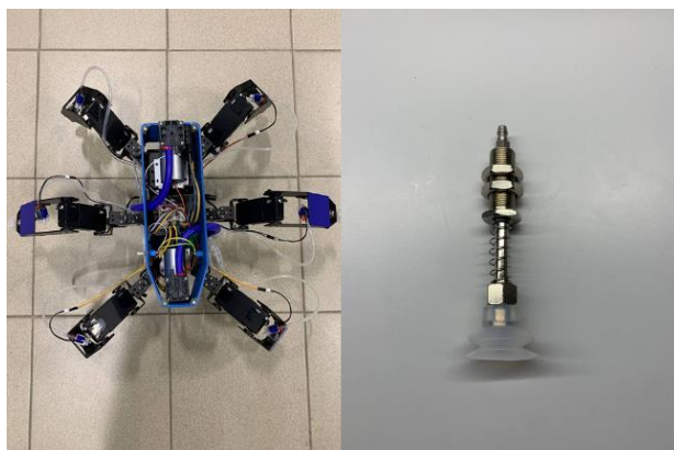
Рис. 1. Вакуумная система: вакуумные насосы, пневмоклапаны, фитинги, силиконовые присоски
