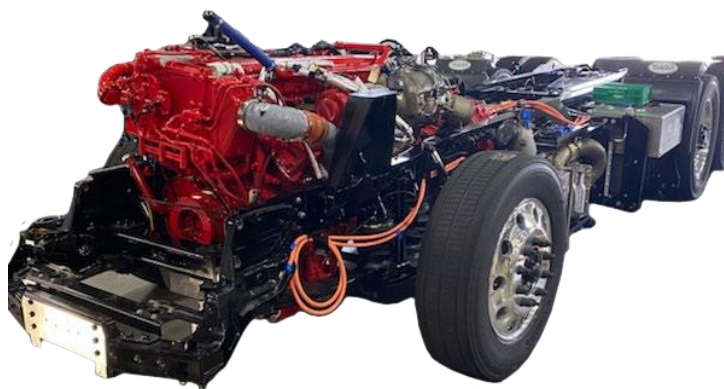
Рис. 2. Демонстрационная силовая передача на шасси
