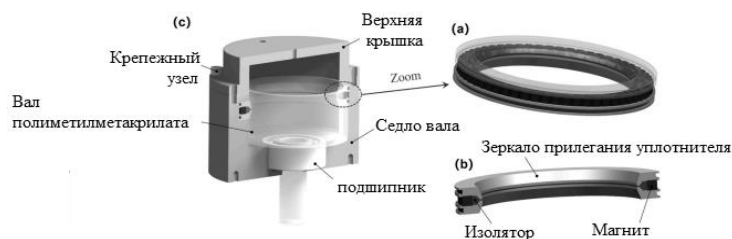
Рис. 3. Схема установки уплотнительных элементов: (а) узел полюса, (б) поперечное сечение узла полюса, (в) узел уплотнения
