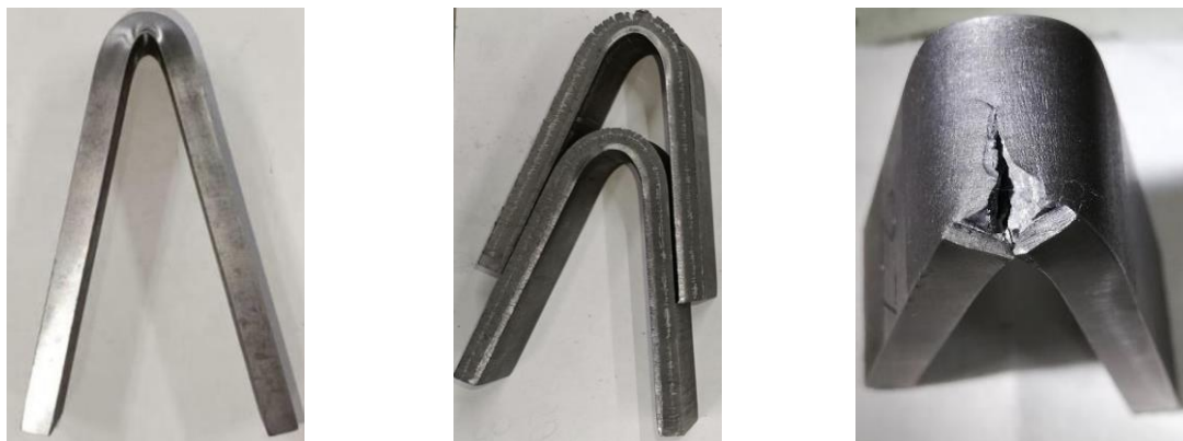
Рис. 3. Образцы после испытаний а) стандартного исполнения; б) с естественным концентратором; в) с V-образным концентратором
