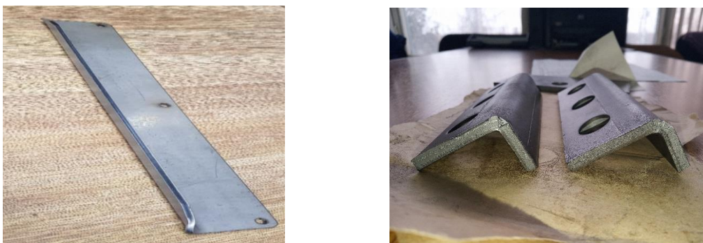
Рис. 1. Пример дефектов деталей: слева – трещины; справа – утяжка полки
