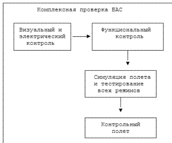
Рис. 16. Схема проверки электронных компонентов после восстановления
