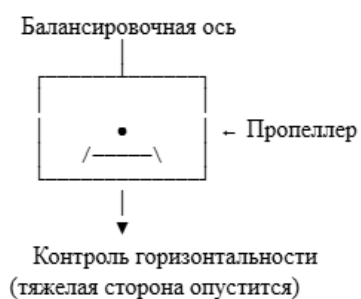
Рис. 30. Схема балансировочного стенда:
