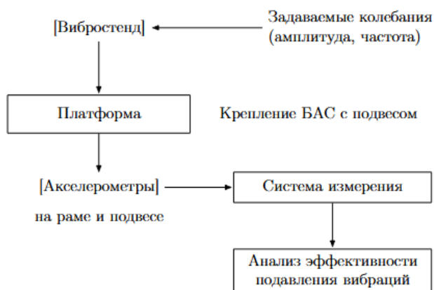
Рис. 76. Схема испытаний на вибростенде
