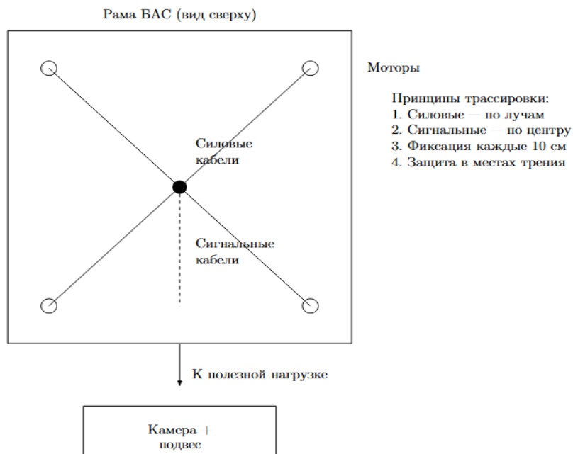
Рис. 67. Правильная трассировка кабелей на БАС
