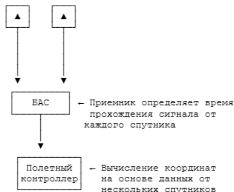
Рис. 7. Принцип работы спутниковой навигационной системы
