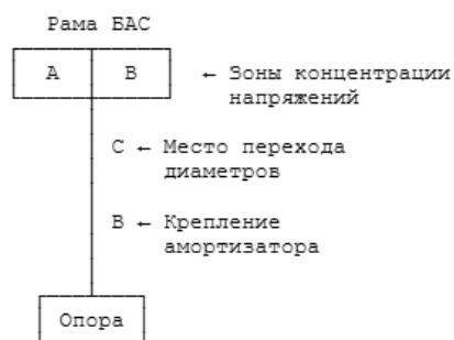
Рис. 28. Типичные места образования трещин в стойках ВПУ
