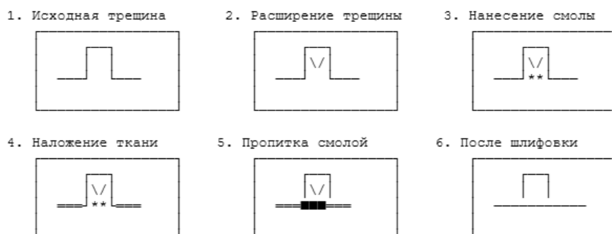
Рис. 13. Последовательность ремонта трещины в композитной раме
