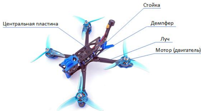
Рис. 3. Основные элементы рамы квадрокоптера
