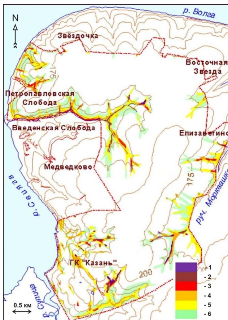
Рис. 3. Комплексная прогнозная схема развития склоновых процессов в 2014 г. на территории горнолыжного комплекса «Казань» и г. Иннополис. Условные обозначения: 1 – неизбежно в течение всего года, 2 – неизбежно весной и осенью, возможно летом, 3 – неизбежно весной, возможно осенью, маловероятно летом, 4 – возможно весной, маловероятно осенью, невозможно летом, 5 – маловероятно весной, невозможно осенью и летом, 6 – невозможно в существующих инженерно-геологических условиях
